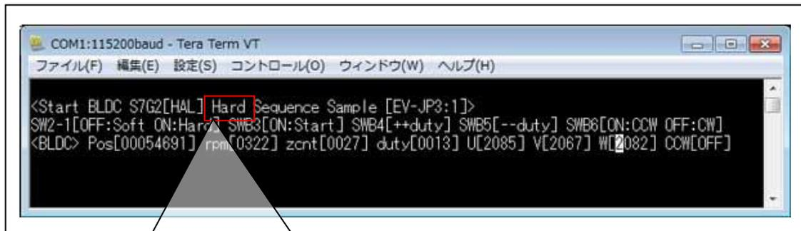
MP 基板上の SW2-1[ON] OPSCR.FB ビット=0 により外部入力による実行
