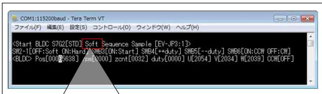
MP 基板上の SW2-1[OFF] OPSCR.FB ビット=1 によりソフトウェアによる実行
